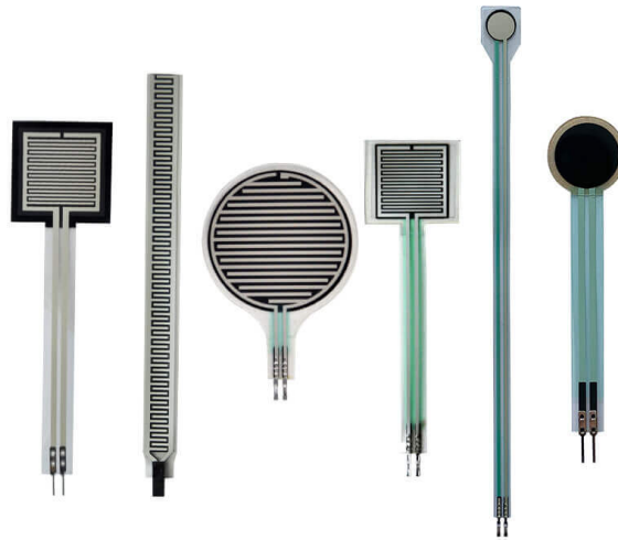
Figura 3 – Exemplos de FSR, com diversos tamanhos e formas
