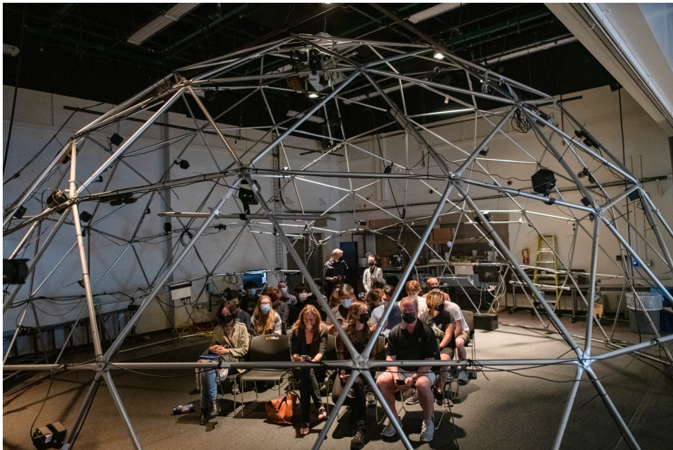
Figura 3 – Arranjo hemisférico de alto-falantes utilizando sistema Ambisonics
